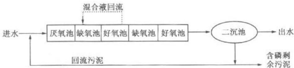
图 3-2 Phoredox 工艺流程示意图
